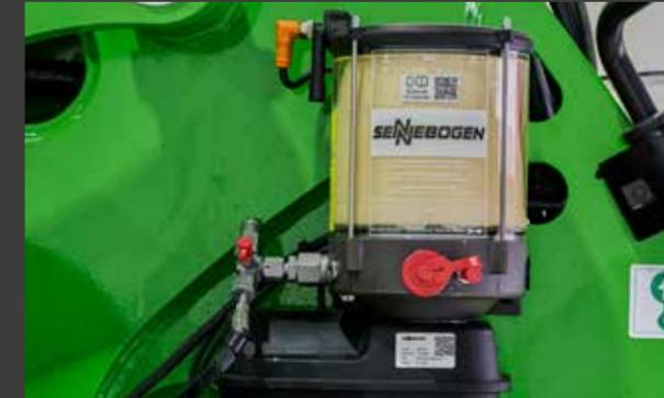
5 L'impianto di lubrificazione centrale garantisce una maggiore durata della macchina grazie a cicli di lubrificazione continui e automatizzati.
