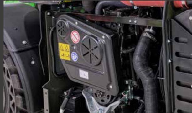
1 Facile accesso a tutti i punti di manutenzione grazie al motore montato trasversalmente.
