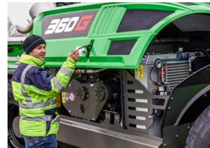
Comodo accesso al vano motore. Cofano apribile con una sola mano per accedere al pannello laterale.
