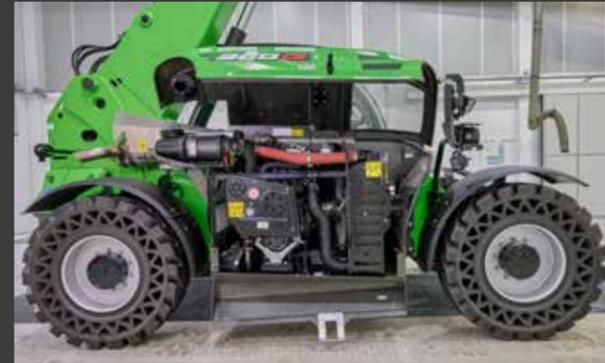
4 Comodo accesso al vano motore. Cofano apribile con una sola mano per accedere al pannello laterale.
