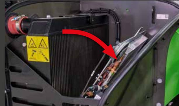
2 Ottima accessibilità al radiatore grazie al condensatore ripieghevole del climatizzatore.
