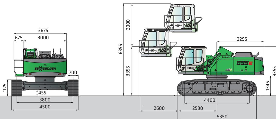
835 R con sottocarri con calibro largo R44D/380 e cabina idraulica elevabile e spostabile in avanti E300/260
