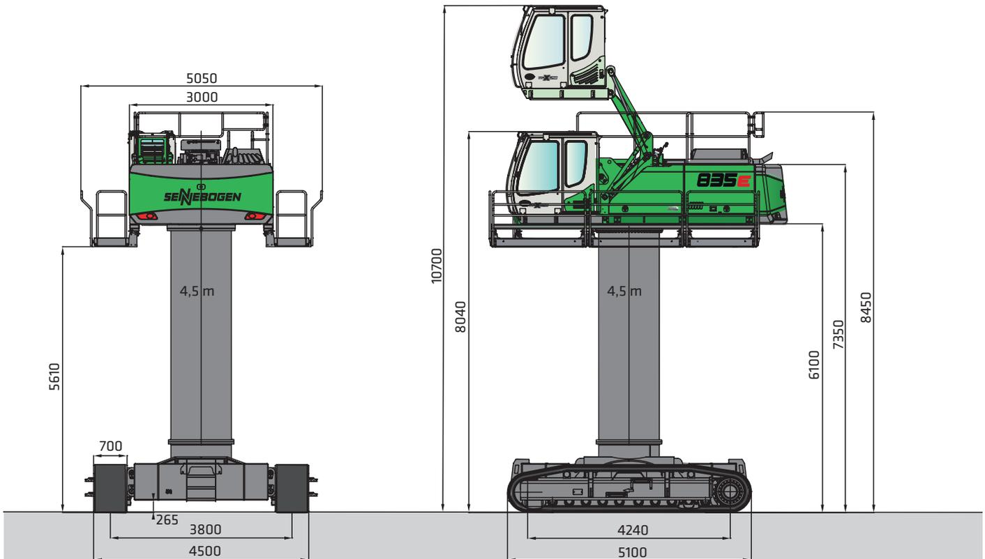
835 R con sottocarro con calibro largo R44D/380, Pilone da 4,5m e cabina elevabile idraulicamente tipo E270
