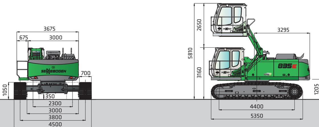
835 R con sottocarri idraulico telescopico T41/380 e cabina elevabile idraulicamente E270
