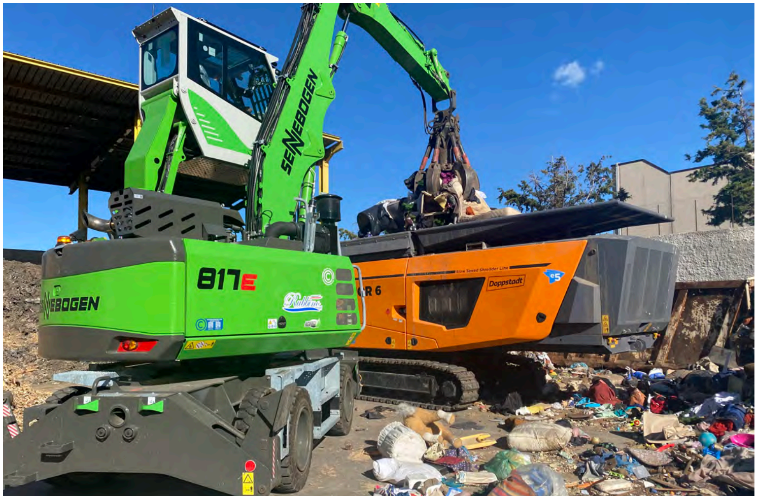
817E - moderno escavatore per la movimentazione dei materiali per lavori di smistamento rapidi e accurati nel settore del riciclaggio dei rifiuti
