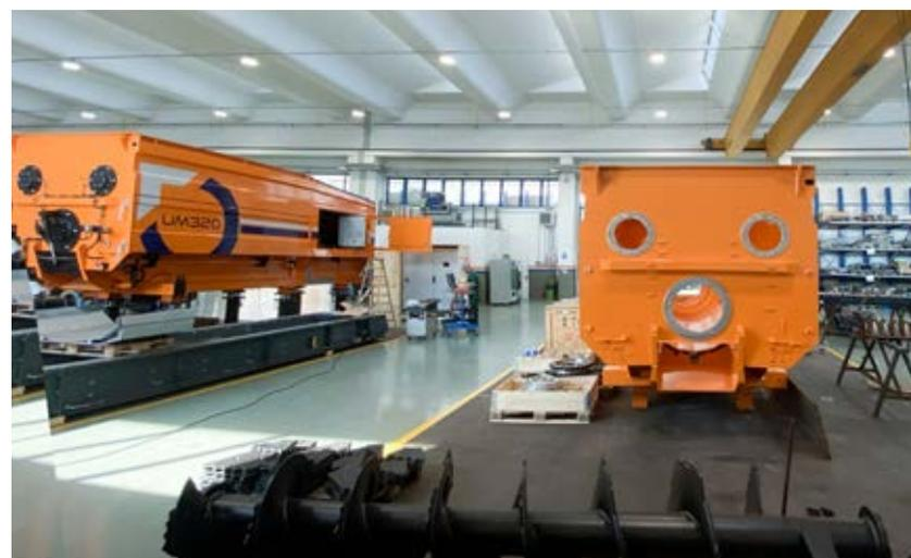
**UM 320 È INFATTI PROGETTATO CON IL PRECISO OBIETTIVO COSTRUTTIVO DEL RIDURRE AL MINIMO I FERMII IMPIANTO; PER QUESTO È STATA SCELTA LA LAMIERA "DURETAL" FACILMENTE SOSTITUIBILE QUANDO IL SUO SPESSORE SI RIDUCE AL MINIMO, SENZA MAI DOVER INTERVENIRE SUL TELAIO.**
