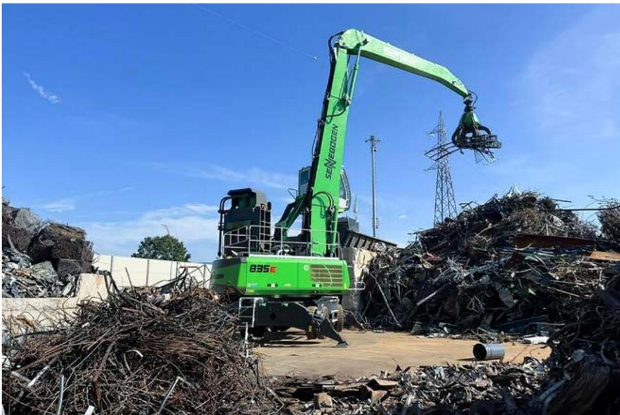
**IL SISTEMA DI CONTROLLO ELETTRICO DELLE PORTATE IDRAULICHE CHE ANALIZZA IL FLUSSO DI OLIO E LE PRESSIONI, PERMETTE UNA RISPOSTA IMMEDIATA DELL'ATTREZZATURA QUANDO È RICHIESTA E UNA MAGGIORE SENSIBILITÀ DURANTE L'USO.**
