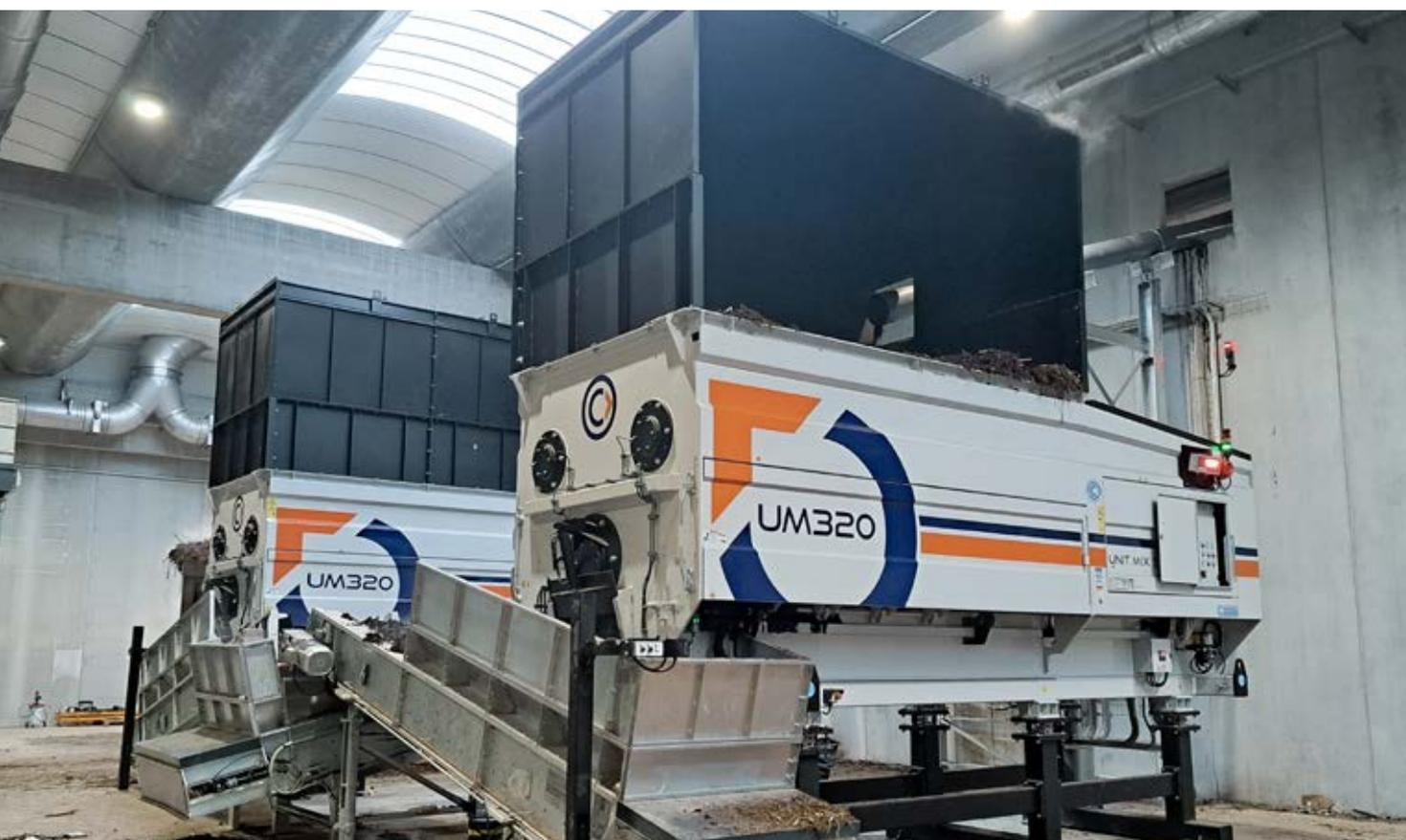
conseguente aumento dei consumi elettrici. A protezione del motore elettrico da eventuali sovraccarichi è interposta una turbofrizione, del tipo già presente sulle macchine Doppstadt di triturazione, con l'apposita spina che viene sganciata in caso di necessità, preservando così tutta la componente meccanica. Tutto ciò viene opportunamente segnalato, unitamente ai segnali di sicurezza e a quelli inerenti le modalità di lavoro, su un pannello che può
