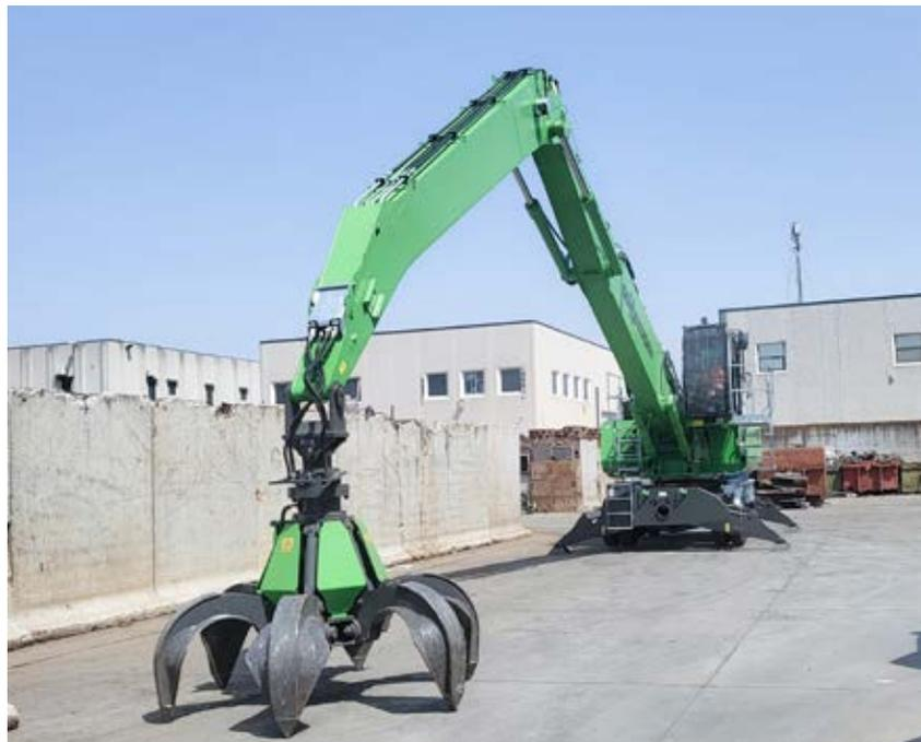
**ULTIMI ACQUISTI SONO I SENNEBOGEN 835E, QUESTE 2 MACCHINE SONO STATE EQUIPAGGiate SU MISURA PER LE ESIGENZE DI PRODUZIONE CAIAZZO IN QUANTO ADOTTANO UN BRACCIO K18 E UNO SPECIALE SISTEMA DI INNALZAMENTO CABINA... IL TUTTO UNITO AD UN SISTEMA DI ILLUMINAZIONE A LED MAGGIORATO**
