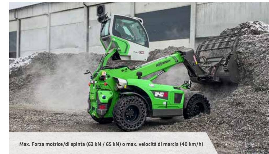
Max. Forza motrice/di spinta (63 kN / 65 kN) o max. velocità di marcia (40 km/h)
