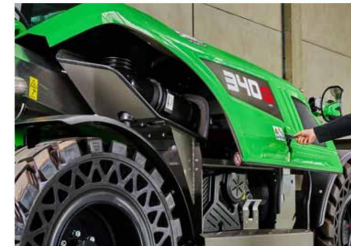
Comodo e sicuro accesso al vano motore. Cofano apribile con una sola mano.
