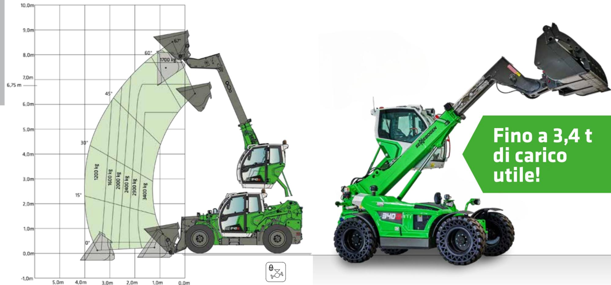
I carichi indicati valgono solo per l'utilizzo della benna di carico SENNEBOGEN con capacità di carico di 2 m<sup>3</sup>. È necessario tenere conto delle densità di massa ammesse. Il peso netto della benna è compreso nel carico utile. L'avanzamento dei carichi utili deve avvenire in posizione di trasporto con braccio mono-telescopico abbassato.
