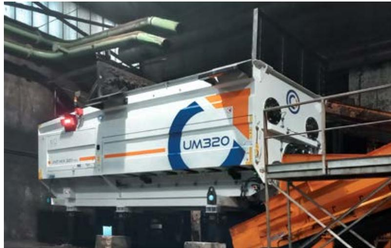
Da questa necessità è stato sviluppato UM 320 che fa tesoro dell'esperienza acquisita nel tempo ed è caratterizzato da una robustissima costruzione in acciaio, dalla particolare conformazione e dimensioni degli alberi di miscelazione, da un potente e affidabile sistema di trasmissione e dall'accessibilità alla camera di miscelazione da ambo i lati grazie all'apertura di due ampie porte.
