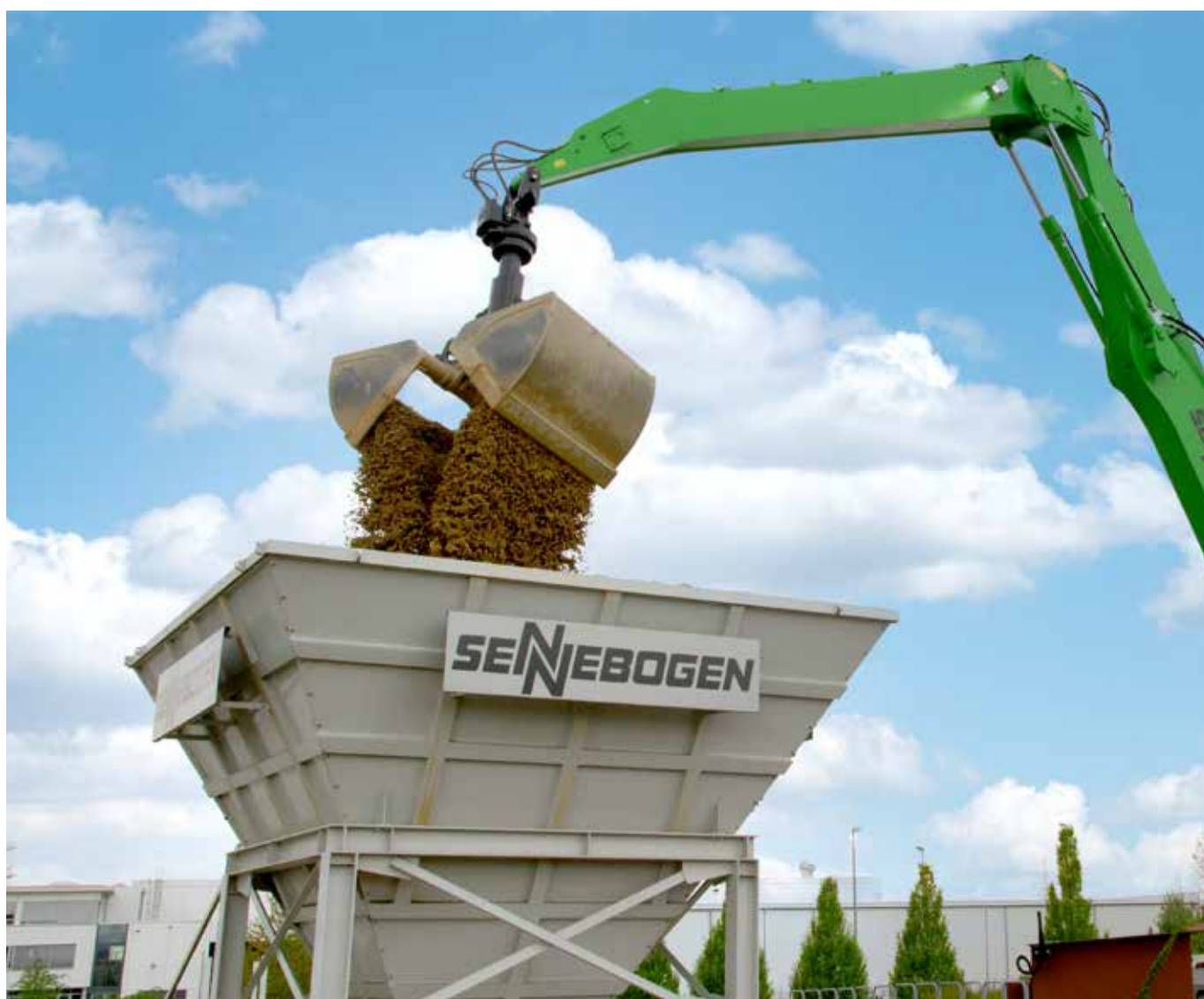
Materiale sfuso (mangimi, carbone, ecc.) con benna mordente (SGZ)
