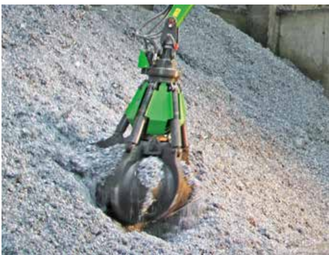
Benna a polipo (SGM), forma a guscio chiusa, per es. per trucioli metallici
