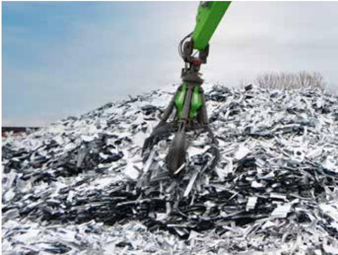
Benna a polipo (SGM), forma a guscio semiaperta, per es. per scarti di lamiera
