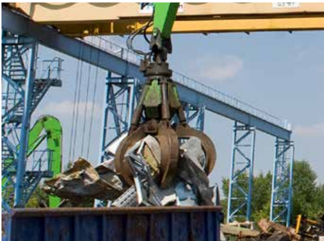
Benna a polipo (SGM), forma a guscio semiaperta, ad es. per rottami misti
