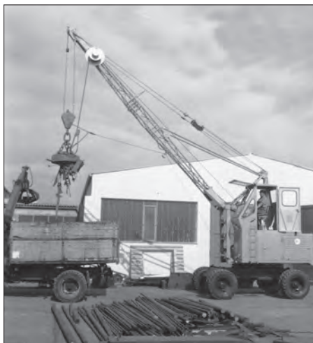
1962: caricatore a fune S833 con cabina operatore elevabile
